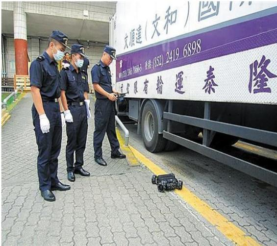
灵活聪明的“机器人”钻入到车辆底部，伸出摄像头将车辆底部图像迅速扫描，而在远处，“特工”们紧张地观察和分析着手中显示屏上同步显示着的扫描图像……这一科幻大片中的情景真实地发生在深圳海关的查验现场，只不过，“特工”变成了海关的查验关员。6月17日，“全向车底盘检查机器人”在皇岗海关货运查验现场和旅检小车查验现场正式启用。这也是全国海关首批启用的底盘检查机器人，目前正在深圳、珠海、东莞和哈尔滨进行试点运行。
